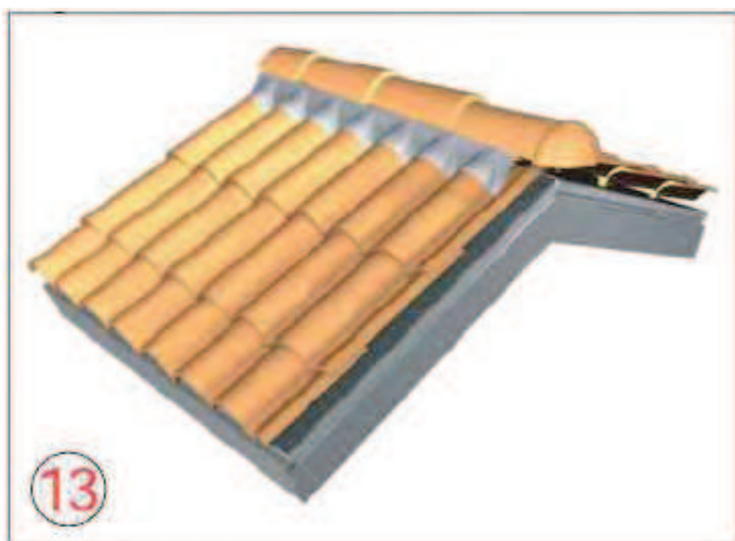
13 - Steso un cordone di silicone, far aderire bene le bandelle in piombo plissettato sul manto di copertura;
